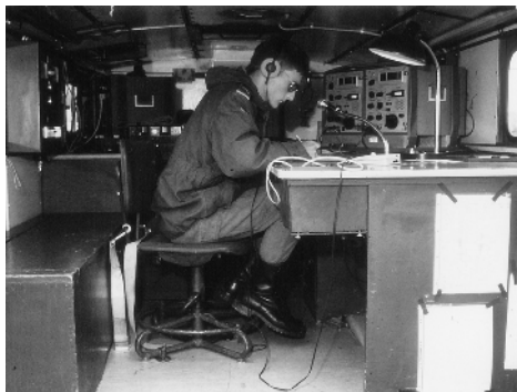
Bild 10 (links) - Behelfsrüstsatz für den HF-Horchtrupp, noch mit Empfänger EK 07: Von der Truppe in Kleinserie angefertigter Einbau für Lkw 1,5t gl („Unimog“) aus Tischlerplatten, Lochprofileisen und handelsüblichem Installationsmaterial; Bild 11 (mitte) - Nach dem Vorbild der Behelfslösung industriell gefertigter „Rüstsatz Horchtrupp Nah“, inzwischen bestückt mit zwei Empfängern E 863 an jedem der beiden Arbeitsplätze; Bild 12 (rechts) - Auswertekarte im mobilen Peilauswertetrupp HF in Lkw 5t gl geschl
