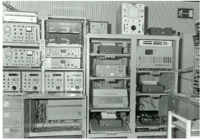
Bild 20: Schreibfunk-Erfassungsplatz mit Empfangsgestell (links; mit je vier Empfängern und Tastgeräten) sowie Aufzeichnungs- und Analysegerät (rechts)
