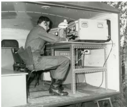
Bild 10 (links) - Behelfsrüstsatz für den HF-Horchtrupp, noch mit Empfänger EK 07: Von der Truppe in Kleinserie angefertigter Einbau für Lkw 1,5t gl („Unimog“) aus Tischlerplatten, Lochprofileisen und handelsüblichem Installationsmaterial; Bild 11 (mitte) - Nach dem Vorbild der Behelfslösung industriell gefertigter „Rüstsatz Horchtrupp Nah“, inzwischen bestückt mit zwei Empfängern E 863 an jedem der beiden Arbeitsplätze; Bild 12 (rechts) - Auswertekarte im mobilen Peilauswertetrupp HF in Lkw 5t gl geschl
