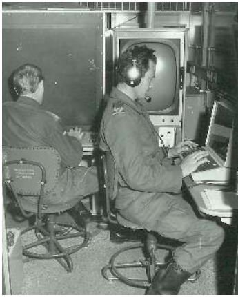
Bild 9 (links): Blick in die Rechner-Kabine der Auswertezentrale des ETEKE: rechts der Arbeitsplatz des "Vorauswerters" (des späteren "Sofortauswerters"); links hinten der Schirm des (späteren) "Leiters der Aufklärung" zur gleichzeitigen Film-Projektion von Landkarten und Daten-Projektion taktischer Zeichen; rechts hinten der gemeinsame Schirm zur Anzeige alphanumerischer Daten
