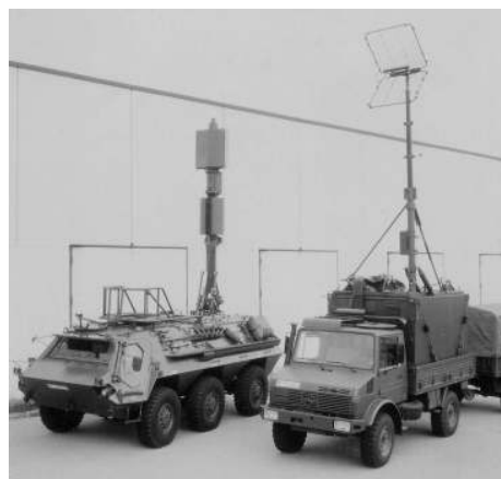
Bild 23 (links): Fertig entwickelte EloAufkl-Trupps der Firma Siemens: Hinten der EloAufkl-Panzer HELAS mit aufgerichteter Fünfband-Monopuls-Antenne, darunter die Schlitzantennen der Peilkommando-/Meldeverbindung; vorn der Zugauswertetrupp mit Cornerreflektorantenne der UHF-Datenübertragung (genauso sah auch der Datenübertragungstrupp UHF aus).
