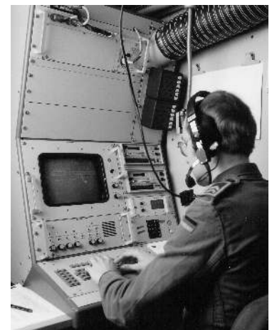
Bild 14 (rechts): Erfassungsarbeitsplatz zur Tastfunk- und Schreibfunkaufnahme mit Bildschirm und Tastatur des Terminals, Bandaufzeichnungsgeräten und Wechselsprechanlage (Prototyp)
