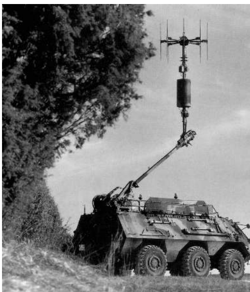
Bild 16 (links): VHF-Peilpanzer mit halb aufgerichteten Antennenmast. Hinter der tonnenförmigen Verkleidung unterhalb der Peilantenne runden Schlitzantennen für die UHF-Peilkommando-Verbindung
