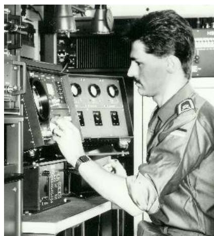
Bild 10: Peiltrupp HF mit Peilanlage PS 74 in Kabine I: Vor dem Bediener links der handbediente Peilempfänger, rechts die Anzeigeröhren der vier automatischen Peilkanäle
