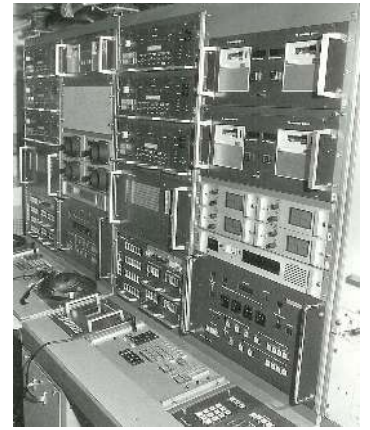
Bild 9 (links): Blick in die Rechner-Kabine der Auswertezentrale des ETEKE: rechts der Arbeitsplatz des "Vorauswerters" (des späteren "Sofortauswerters"); links hinten der Schirm des (späteren) "Leiters der Aufklärung" zur gleichzeitigen Film-Projektion von Landkarten und Daten-Projektion taktischer Zeichen; rechts hinten der gemeinsame Schirm zur Anzeige alphanumerischer Daten
