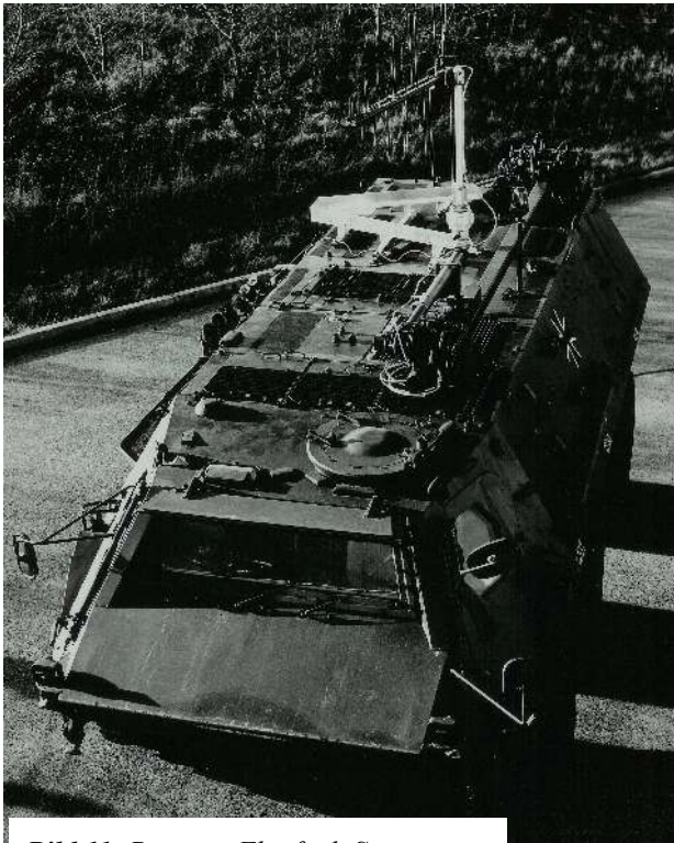
Bild 11: Prototyp Flugfunk-Störtrupp UHF „Wespe“ in TPz EloKa, mit dreh- und schwenkbarer L/p-Antenne
