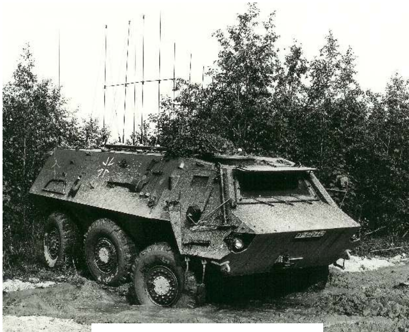
Bild 7: Störsender 33 ("Hummel"), eingebaut in TPz EloKa. In Längsrichtung auf dem Fahrzeug die LPU-Richtantenne, achtern die beiden Fahrzeugantennen SEM 25. Eine der beiden hinteren Türen mit dem Wärmetauscher, Schwimmtrieb ausgebaut
