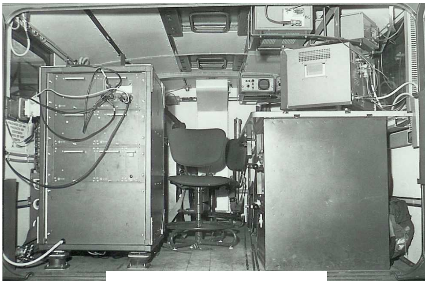
Bild 9: Kommandogerät Störsteuerung (links) im FmAufklGerSatz 1-80 MHz
