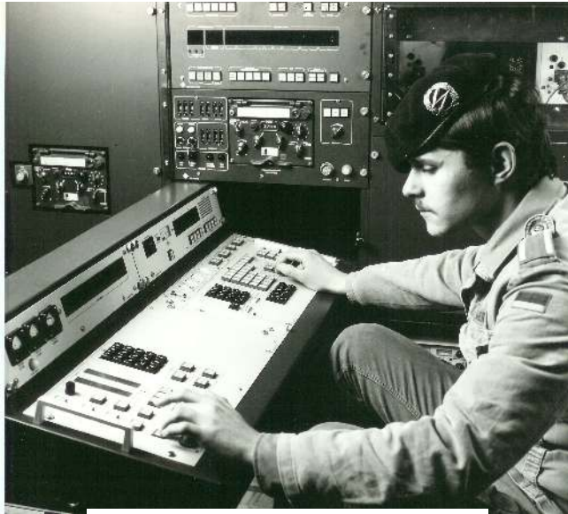
Bild 8: Hauptarbeitsplatz des VHF-Störtrupps: Bedienfeld seitlich herausgezogen in Betriebsstellung, dahinter Bedienfelder und Funkbediengeräte SEM 25
