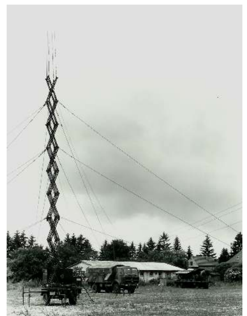
Bild 4 (links): Scherenmast des Antennenanhängers teilweise ausgefahren Bild 5 (rechts): Störsender 23 mit Senderfahrzeug, Aggregateanhänger und voll ausgefahrene Scherengitterantenne (Marineversion)
