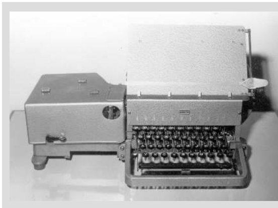
Bild 4 (links) - Tastenlocher TL1a der Firma Hell
