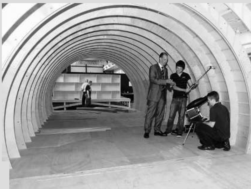
Nicht von Pappe: Akustikmessung im Holztunnel
