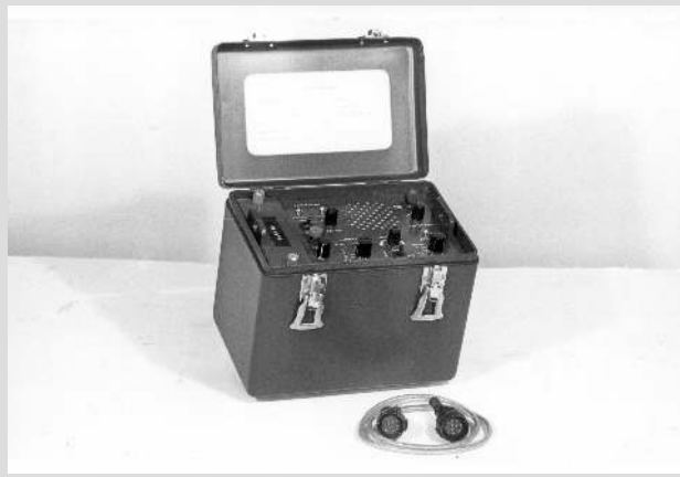
Bild 9 - "Simulator Funkstörung EloSM-Ausbildung" der Firma LAW
