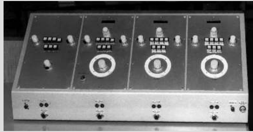
Bld 7 - "Übungsgerät Peilfunkausbildung" der Firma C.Plath zur Simulation von drei Sendern unterschiedlicher Art und Richtung
