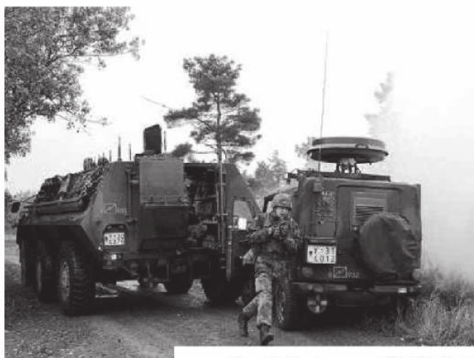
Der Geländewagen "EULe", das „Elektronische Unterstützungsgerät leicht“, ist mit einer Peilanlage ausgestattet
