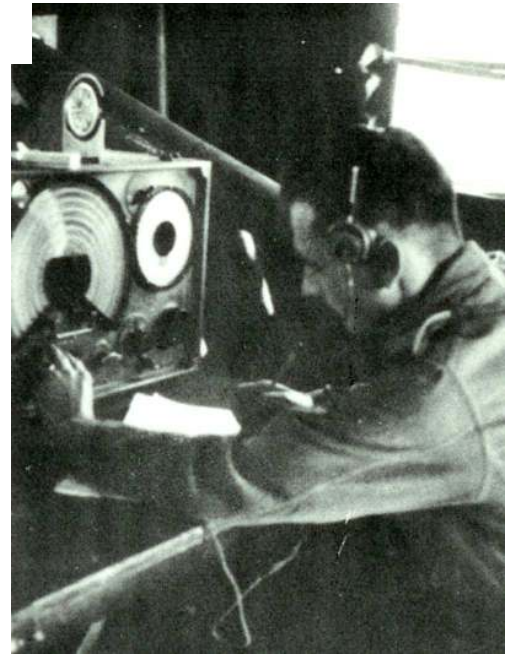
Bild 8: Peilfunker am Goniometer-Peilempfänger 875-3750 kHz, aus [1]
