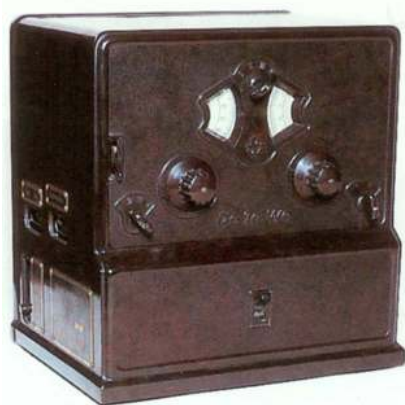
Bild 10: Dieser Dreiröhren-Rundfunkempfänger der Firma DeTeWe von 1929 sah weniger spektakulär aus, war sicherlich einfacher zu bedienen und entsprach wohl eher den Vorschriften der Genehmigungsbehörde; Abb. aus [15]. Der Besitzer benötigte nur eine Rundfunkgenehmigung; die Erteilung von Audion-Versuchserlaubnissen war inzwischen aber eingestellt worden.
