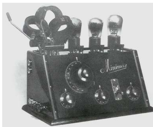
Bild 9: Gegen Mitte der 20er Jahre industriell hergestellter Röhrenempfänger, aus [14]: Es ist allerdings fraglich, ob dieses Gerät mit seinen Schwenkspulen und frei zugänglichen Röhren in Deutschland als „nicht veränderlich“ eingestuft worden wäre und den Freibestempel erhalten hätte.
