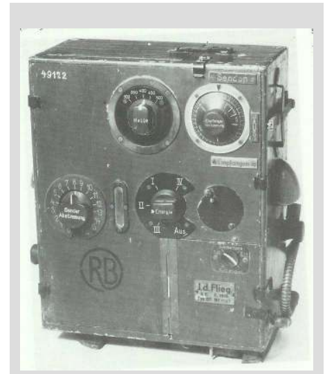
Bild 3 (oben): Mittelwellen-Fliegerfunkgerät „Typ D“: Sendeempfänger mit fünf Festfrequenzen, Löschkundenstrecke 125W mit Energieversorgung aus Windschraubengenerator. Bild aus [1].
