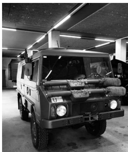
Bild links: Funkwagen Pinzgauer 4x4, aus Platzgründen sind die Geroh-Antennenmasten auf der Kühlerhaube montiert (1980er-Jahre); Bild unten: Schnell-Telegrafanlage für KW-Funkanlagen, 20 - 900 ZpM (1948)
