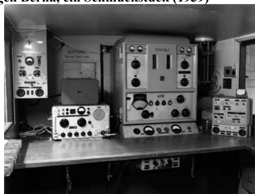
Bild links: FL 19/25 (Fahrbar leichte Funkstation) auf Protze (1919, modernisiert ab 1924), Bild mitte: KW-Funkstation SE-403/MIK eingebaut in Lastwagen Saurer (1947); Bild rechts: Neu restaurierter Peilwagen Berna, ein Schmuckstück (1939)
