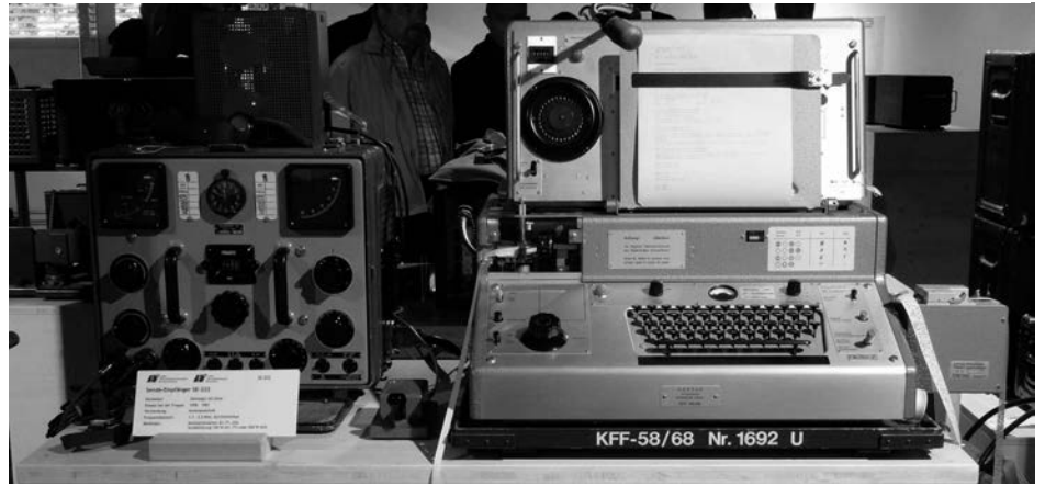
Bild links: Ausrüstung der Brieftauben-Einheiten, präsentiert in einem Auszugsschrank; Bild oben: Grenzwellen-Funkstation SE-222 mit Kryptofunkfern­schreiber KFF (1958), die Anlage chiffriert online und läuft synchron mit der Gegenstation
