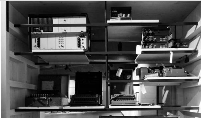
Chiffriergeräte in Auszugsschrank, Mitte link ENIGMA Typ K (1939), daneben NEMA (1948), oben rechts SVZ-B, damit wurden ab 1984 alle VHF-Sprechfunkverbindungen (RT-524 + PRC-77) verschlüsselt
