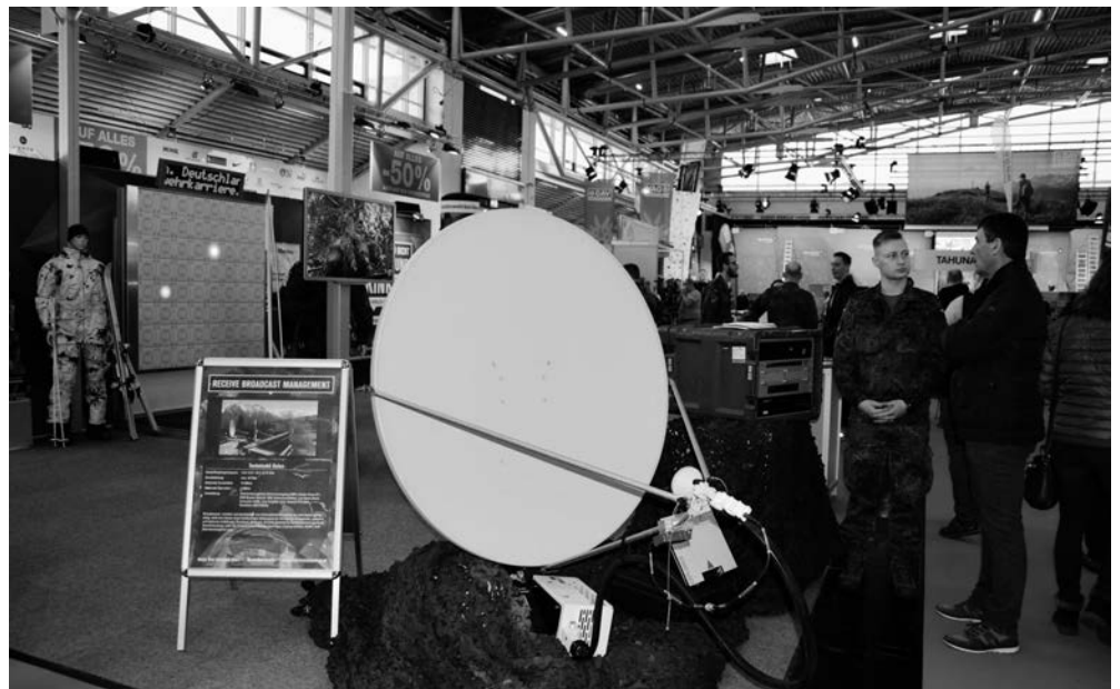
Das Receive Broadcast Management System, kurz RBM, stellt unter anderem die Verbindung via Satellit vom Einsatzland ins Heimatland bereit. Oberfeldwebel Krause erklärt im direkten Gespräch die Funktionsweise des IT-Geräts. Foto: Jenny Henning
