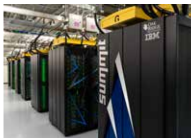
Abb. 1: Summit ist ein Supercomputer des Unternehmens IBM, der im Oak Ridge National Laboratory in den USA im Juni 2018 in Betrieb genommen wurde. Zum Zeitpunkt der Inbetriebnahme war er der schnellste Supercomputer der Welt; 4608 Rechner füllen über 200 Standard-19-Zoll-Racks, auf 520 qm, Foto: Urheber – Carlos Jones/ORNL; Quelle: https://commons.wikimedia.org/w/index.php?curid=73905694
