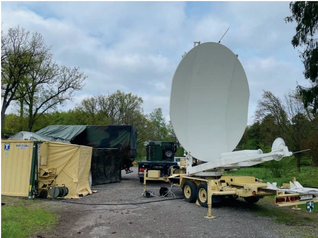
SatCom-Antenne für breitbandige Satellitenverbindung. Insgesamt vier Soldaten überwachen im „24/7“-Schichtdienst den Betrieb Bild: Bundeswehr/Lena Schiehandl
