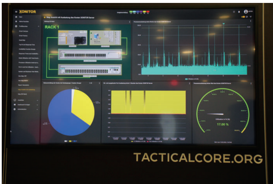
Bild 5: Detailansicht Auslastung eines Netzwerkmoduls im Netzwerkmanagementsystem
