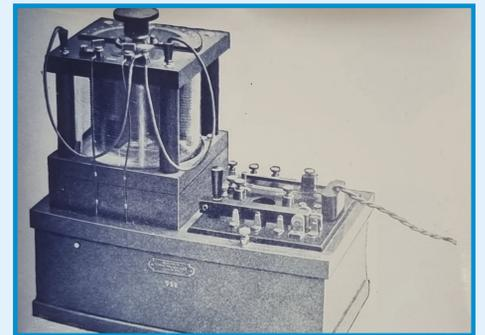
„Schlömilchzelle“ mit variablen Kondensator und Zusatzstöpselkondensatoren für den Hörempfang der übermittelten Morsezeichen (um 1903)
