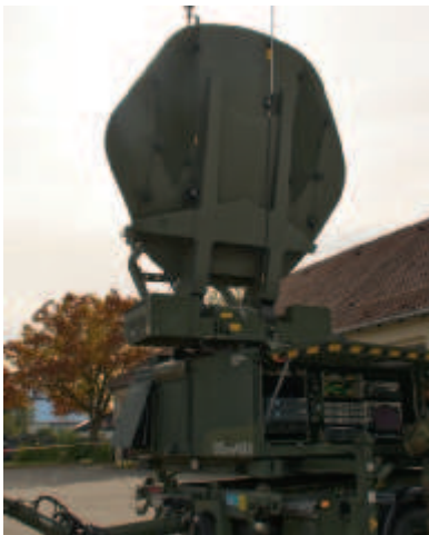
Die Kommunikation über die Satellitenanlage ist die Backup-Lösung für den Fall, dass die Kommunikation über das Internet ausfällt; Foto: Bundeswehr/Jenny Henning
