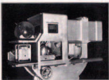
Bild 21. Die geöffnete Kamera zeigt die Bildgitterlinse mit Vorversteller und Ablenkung.
