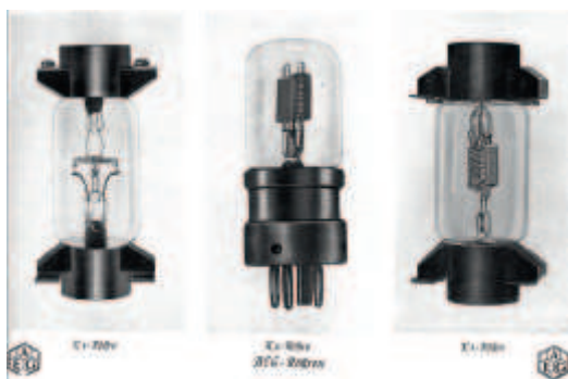
Frühe, im Verstärker KF 4 verwendete AEG-/Telefunken-Röhren; Quelle: Telefunken-Katalog, GFGF-Archiv
