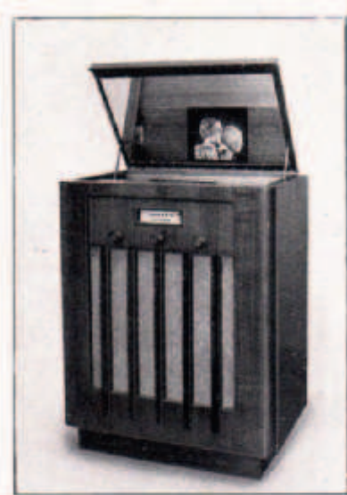
Bild 16. Telefunken-Fernsehempfänger FE V, Modell Funkausstellung 1936. Die Braunsche Röhre steht senkrecht, ihr Schirm wird im hochgeklappten Spiegel betrachtet. 375 Bildzeilen, Zeilensprung, 50 Halbraster/s.
