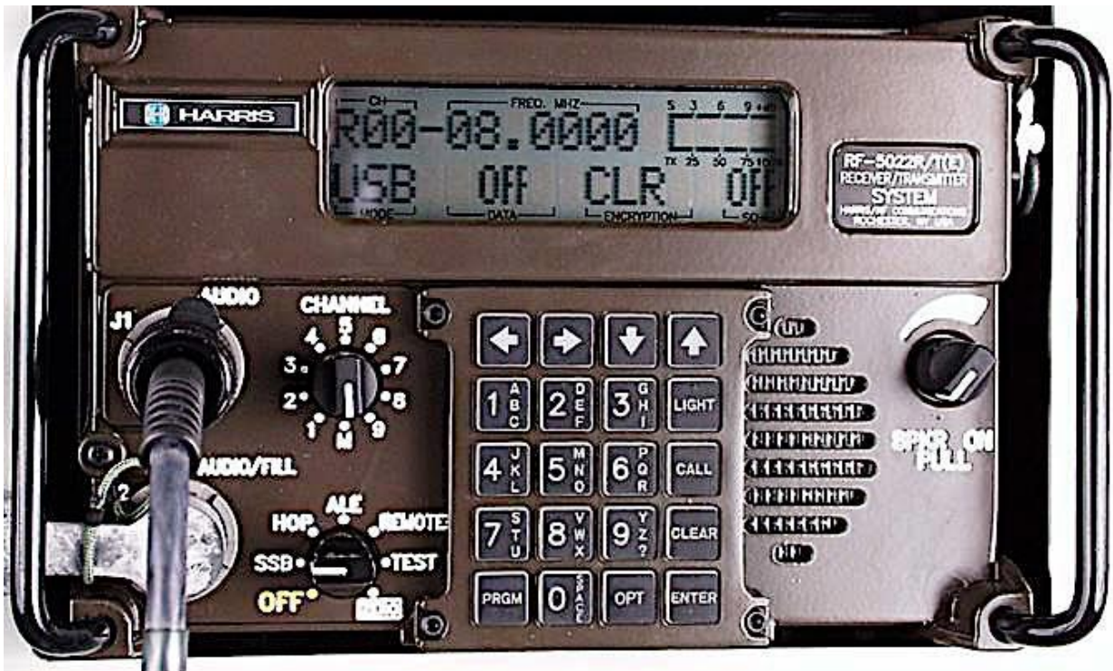
VBS Kurzwellen Sendeempfänger HARRIS RF5022 R/T(E) aus der BF Syst 98 Funkstation.
