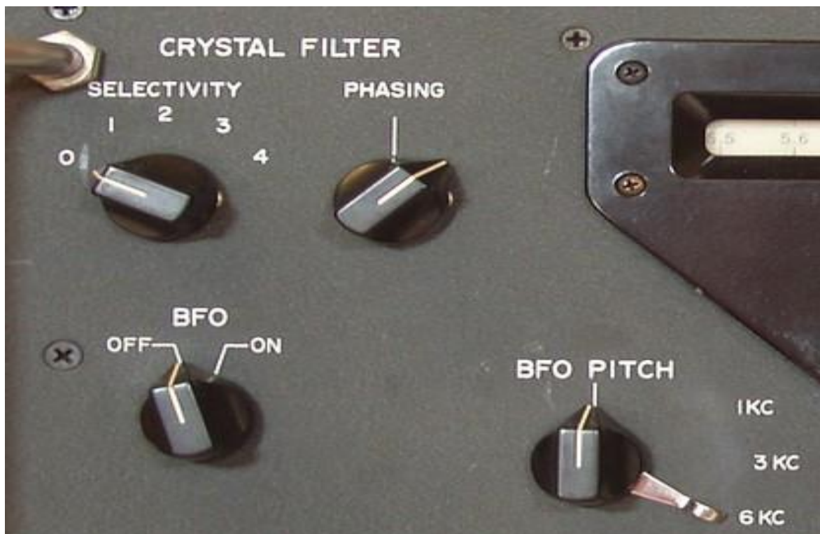
Der Frontplattenausschnitt: Selektionsmöglichkeiten, Telegrafieüberlagerer (BFO)
