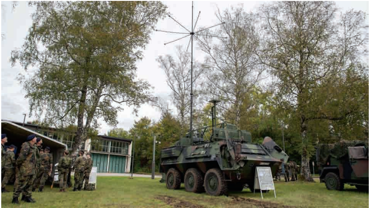
Ein Aufgabengebiet des Elektromagnetischen Kampfes: Elektronisches Stören oder Täuschen gegnerischer Kommunikation mit dem Trupp für Elektronische Gegenmaßnahmen „HORNISSE“, Bild: Bundeswehr/Stefan Uj
