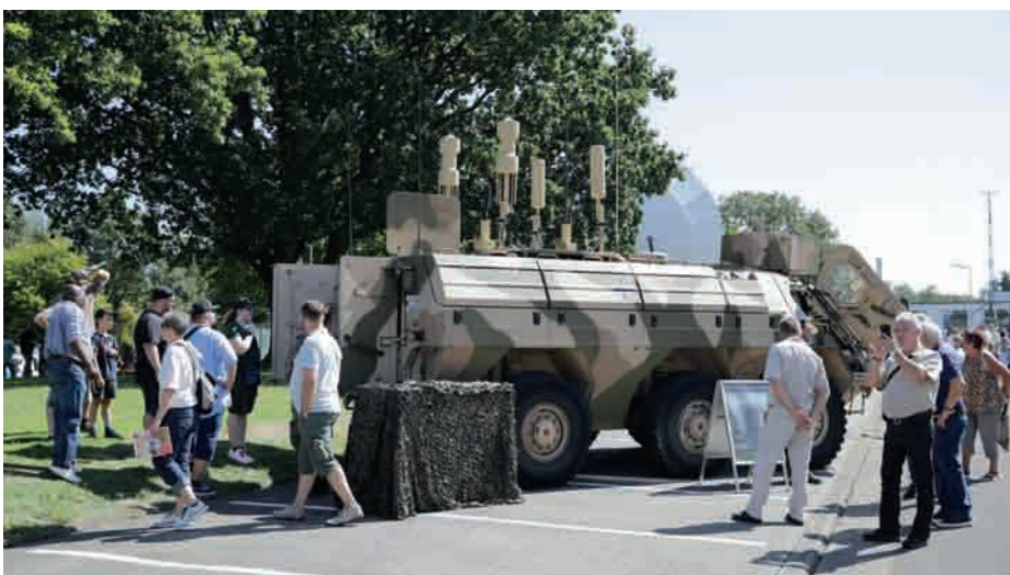
Transportpanzer „Fuchs“ (TPz 1 A8A17) mit Störausstattung CG20+ „small Unmanned Aircraft Systems“ (sUAS), Bild: PIZ CIR/OSFw Michael Rupertus
