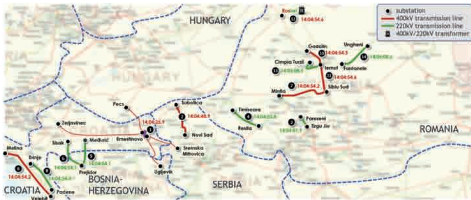
Abb. 2: Abschaltung weiterer Netzelemente nach Eintritt der Störung (Quelle: www.entsoe.eu)
