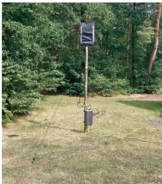
Abb. 3: Die Übertragungseinheit des KNW mit 4G-Basistation,
