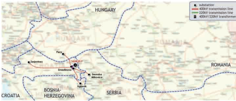
Abb. 1: Abschaltung von zwei Sammelschienen in ERESTINOVO (Quelle: www.entsoe.eu)
