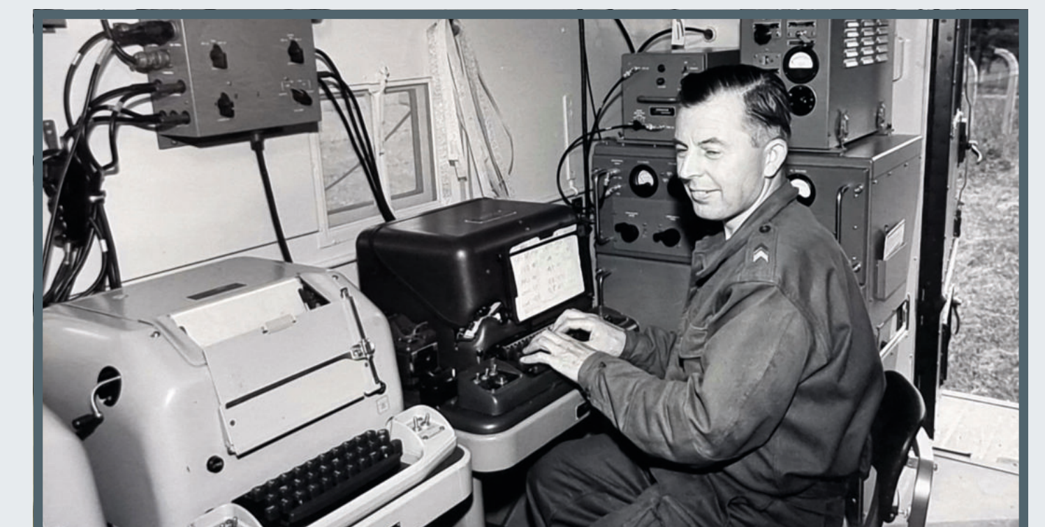
Einer der ersten Funkschreibtrupps - FuSchrGerSatz GRC 26 - Funkschreibeinrichtung (400-Watt-Sender) für mittlere und weite Entfernungen auf LKW mit Kabine
