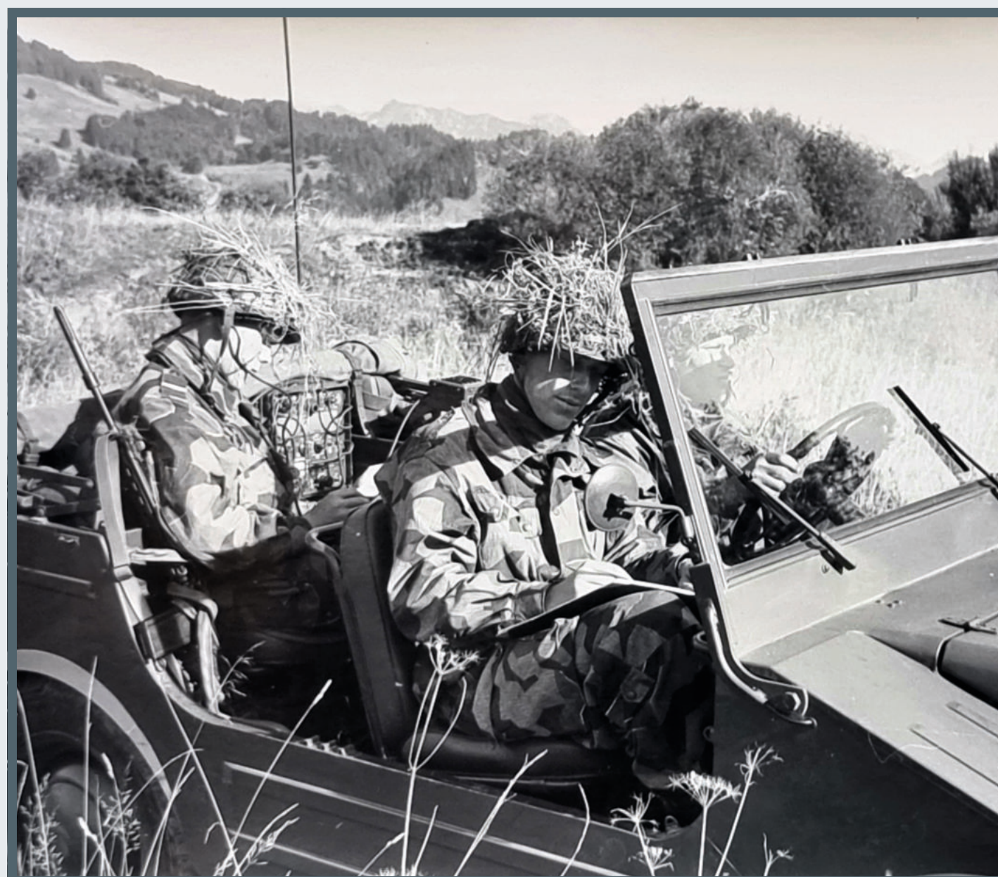
Eines der ersten Funkgeräte - FuGerSatz GRC 9 - Grenz-/KW-Gerät für mittlere und weite Entfernungen auf LKW 0,25 t (DKW)
