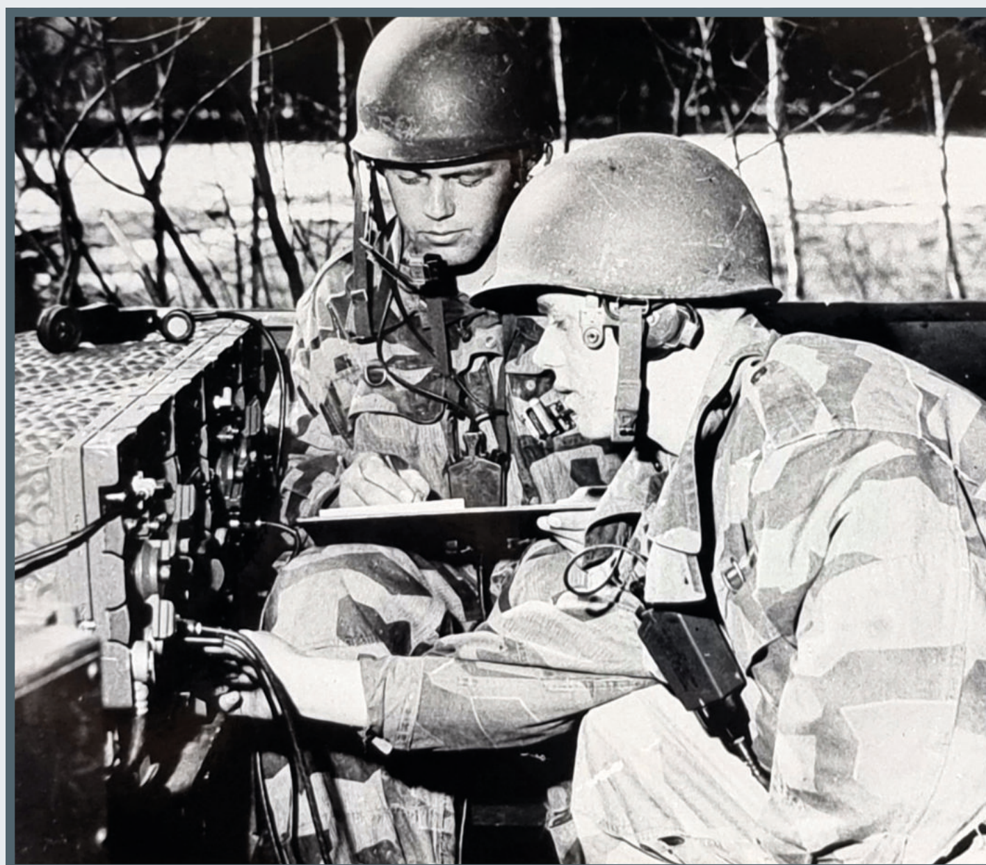
Eines der ersten Funkgeräte - FuGerSatz GRC-3 - UKW-Gerät für kurze Entfernungen auf LKW 0,75 t (Borgward)
