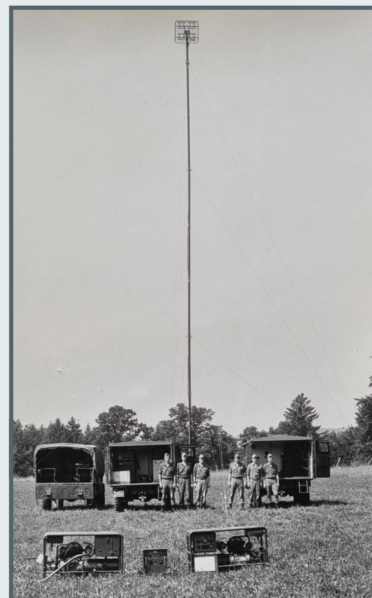
Richtfunktrupp FM 12/800 PCM mit neuer Dipol-Gruppen-Antenne
